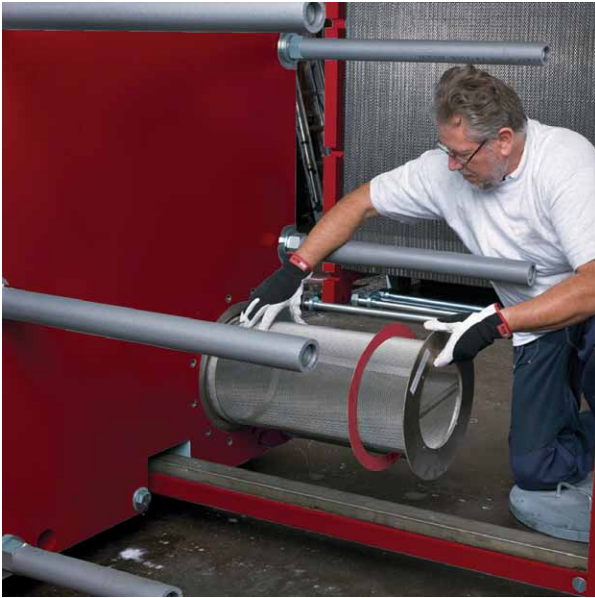
Схема установки фильтра RST в теплообменник PoСВЕП
