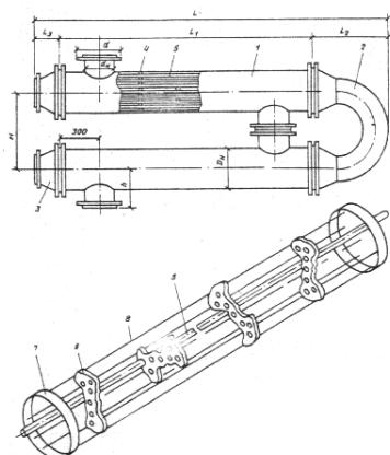
**Рис. 2 Конструктивные размеры водоподогревателя**
