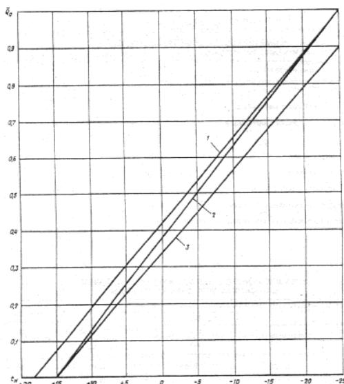
**Рис. 1. Графики относительного изменения теплового потока на отопление  $Q_0$ , в зависимости от наружной температуры  $t_o$  для разного типа потребителей и способов авторегулирования**
