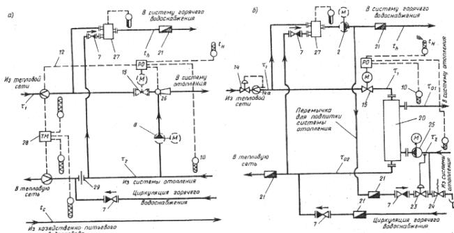
**Рис. 9. Схемы присоединения систем горячего водоснабжения и отопления в ИТП при зависимом (а) присоединении системы отопления через элеватор (пунктиром — с циркуляционным насосом) с учетом теплоты по тепломеру и независимом (б) — с учетом теплоты по водомеру**
