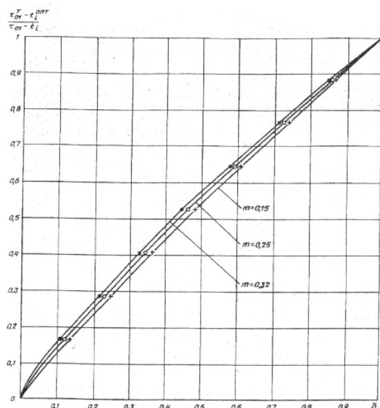
Рис. 2. Графики изменения температурного критерия системы отопления по температуре воды в подающем трубопроводе —  $\left( \frac{\tau_{01}^T - t_i^{opt}}{\tau_{01} - t_i} \right)$  для различных значений показателя степени  $m$  и при постоянной циркуляции теплоносителя в системе
