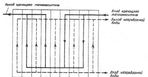
**Рис. 2. Несимметричная компоновка пластинчатого водоподогревателя, обозначение Cx (2+2)/5**
