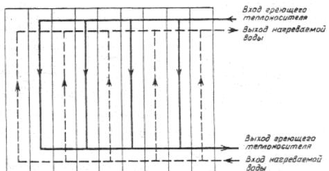
**Рис. 1. Симметричная компоновка пластинчатого водоподогревателя, обозначение Cx 4/5**
